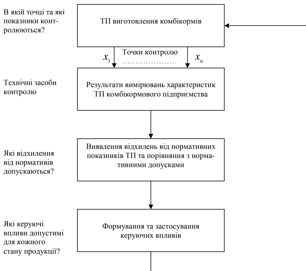
Рисунок 3. Модель БІС контролю якості виготовлення продукції на ПАТ «Миронівський завод з виготовлення круп і комбікормів»
